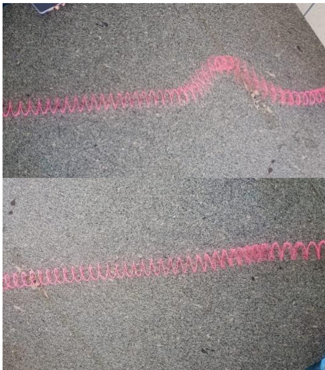
Figura 2 – Onda transversal e longitudinal se propagando na mola maluca
